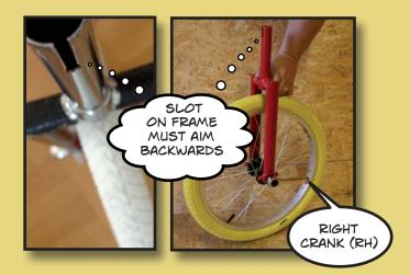
NOW TURN THE FRAME AND WHEEL UPSIDEDOWN AND PUT THE BEARING CUPHOLDERS ON. THE NIB ON THE SCREW SHOULD FIT IN THE SLOT OF THE BEARING CUPHOLDER:
