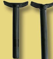
SEATPOST MUST ALWAYS BE INSERTED AT LEAST 6 CM IN FRAME!
