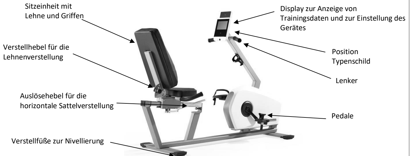
Abb.2: Geräteansicht motion relax 900 & motion relax 900 med mit Benennung der wesentlichen Elemente und Anwendungsteile
