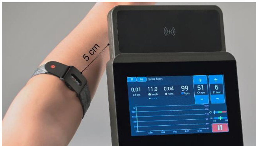
Abb. 11: Pairing eines ANT+ Sensors zur Herzfrequenzübertragung
