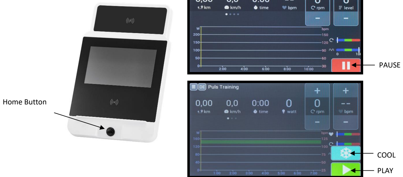
Abb. 9: Monitoransicht, zur Erklärung der Tastenfunktionen, tatsächliche Ansicht kann farblich variieren, Tastenbelegung ist gleich.
