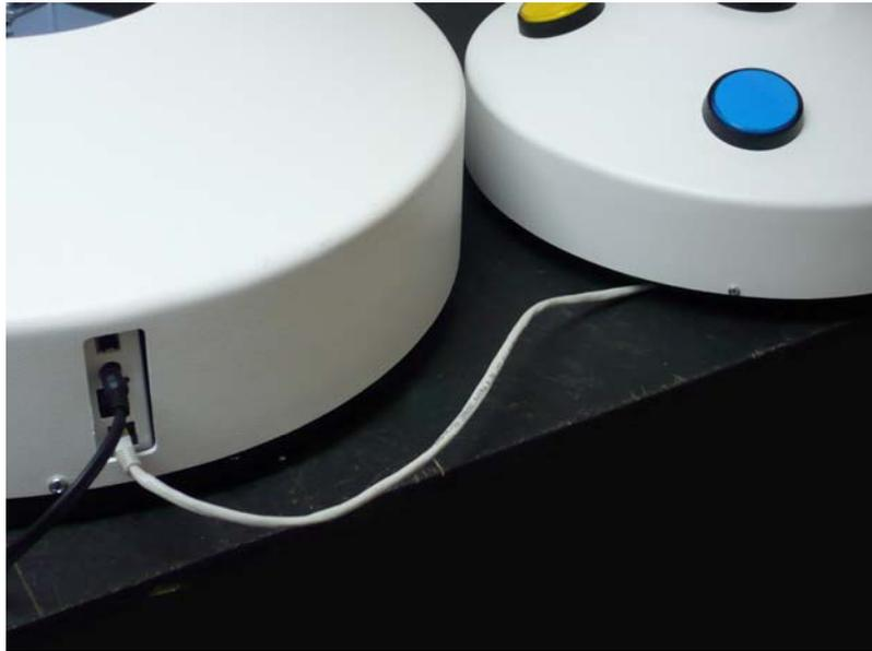
Desligue a sua Coluna de água completamente. Ligue o painel de controlo de cinco botões (A) na base da Coluna de água (J).
