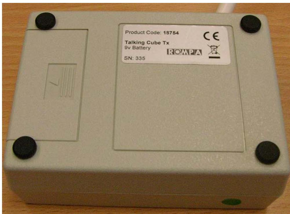
Enlevez la pile usée et la remplacez. Servez-vous d'une pile neuve avec les mêmes caractéristiques techniques. Ne pas essayer d'accéder à l'intérieur de cette boîte. Mettez la boîte grise dans le Cube (***observant les couleurs indiquées***) et fermez la fermeture éclair.
