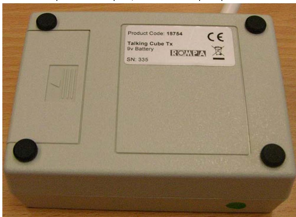
Substitua a pilha gasta por uma nova com as mesmas especificações. Não tente aceder ao interior da caixa. Coloque a caixa cinzenta de novo dentro do cubo e aperte o fecho.
